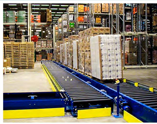
**El transportador de rodillos accionado por cadena** está diseñado para transportar palets y otros artículos pesados con una superficie de apoyo uniforme.
