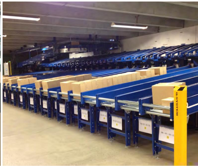
El sistema de transportador de rodillos no accionado Q60 está diseñado para manipular artículos con un peso total de hasta 200 kg por metro. El avance de las mercancías es por empuje o por gravedad cuando el transportador se instala con una caída de 2-5 por ciento.
