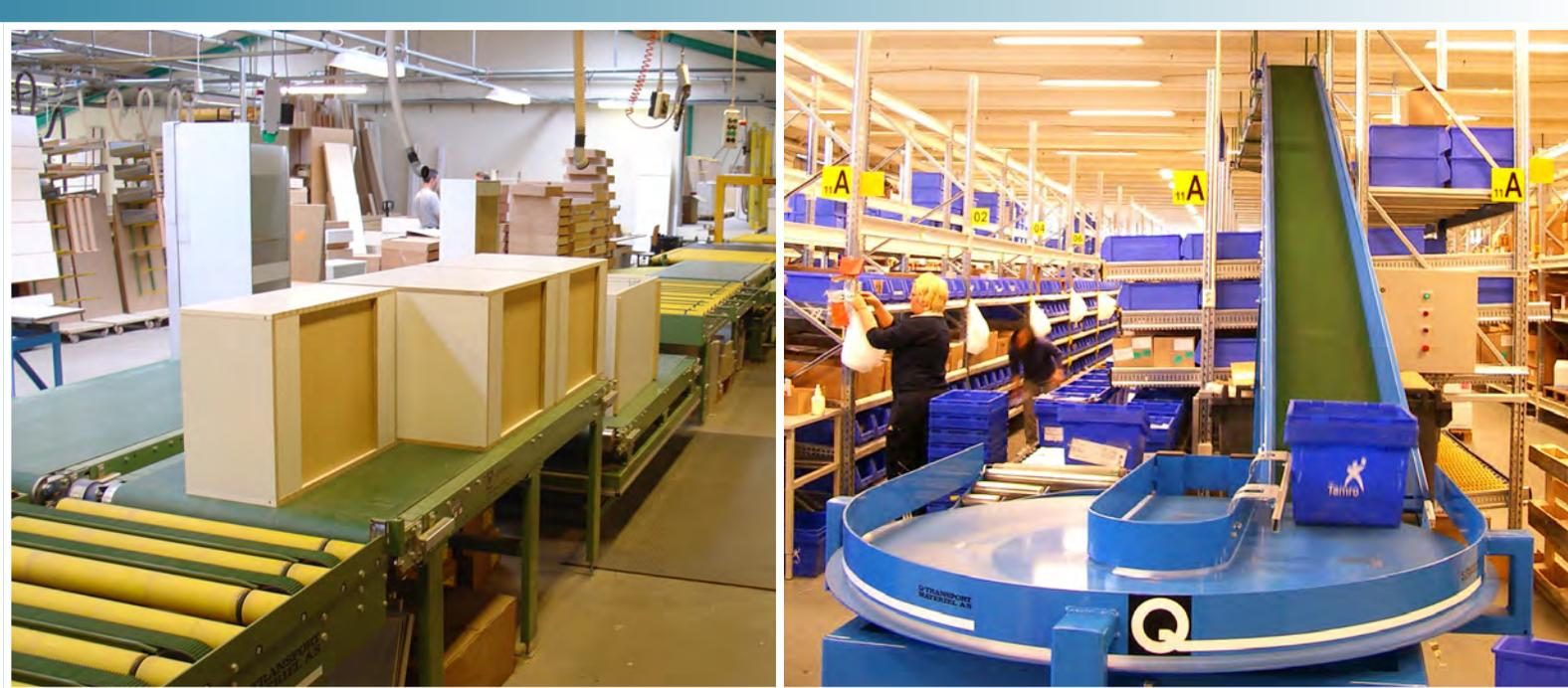
Los componentes estándar del sistema de transportador de rodillos Q67 crean la base para el sistema de transportador habitual.
