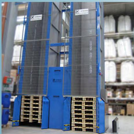
**El Q-Tower** es para el apilado y el desapilado automático de 1, 2, 3, 4, o 5 o otra cantidad completamente diferente de palets a la vez - dependiendo de sus necesidades.
